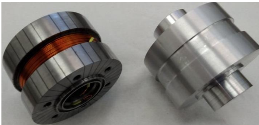
Obr. 5- 12 Drážkované jádro s vinutou cívkou a hliníkovým jádrem pro silikonovou formu
