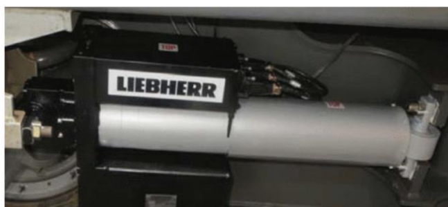
Obr. 2 - 25 Aktivní systém natáčení; reálné zobrazení na podvozku SIEMENS VECTRON [37]
