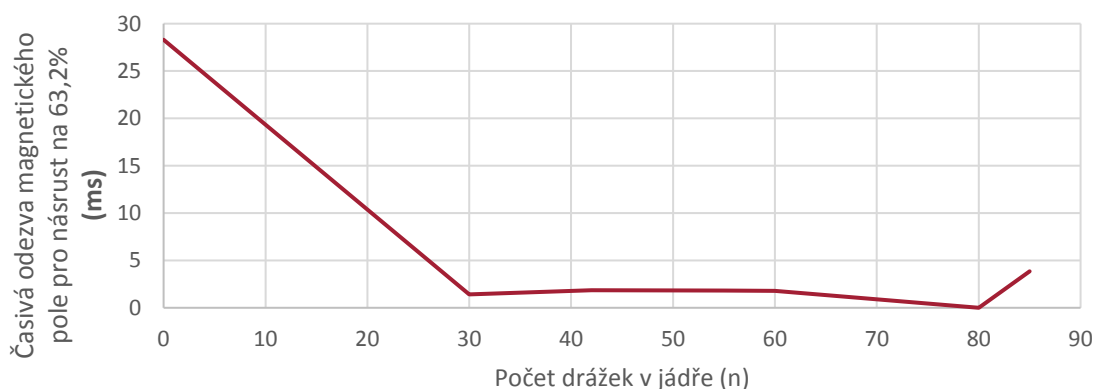
Obr. 5- 8 Závislost časové odezvy mag. pole na počtu drážek (drážky pouze jádro); vířivé proudy jádro
