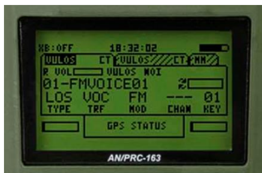
Obr. 2-17 Hlavní menu LCD monitoru radiostanice AN/PRC-163 [6]
