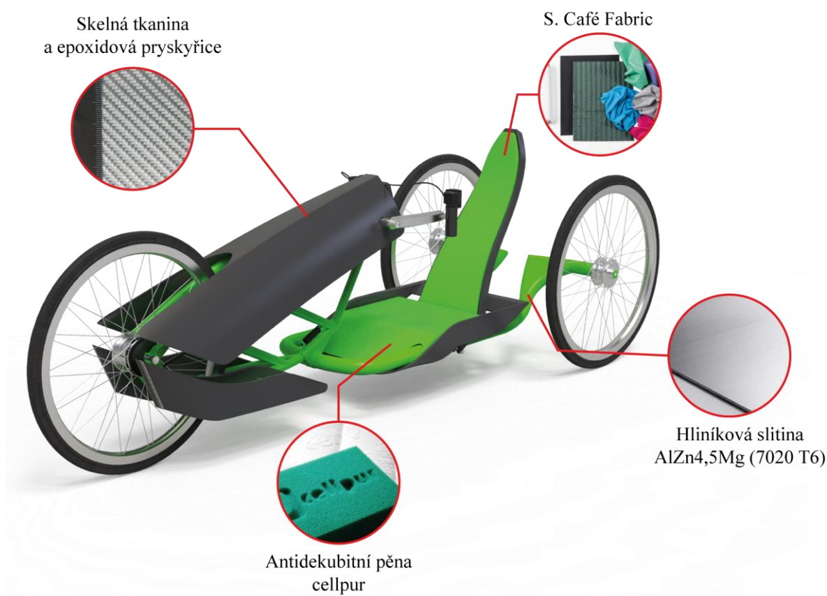
obr. 6-7 Materiálové řešení elektrohandbiku (upraveno) [44], [45], [47], [48]
