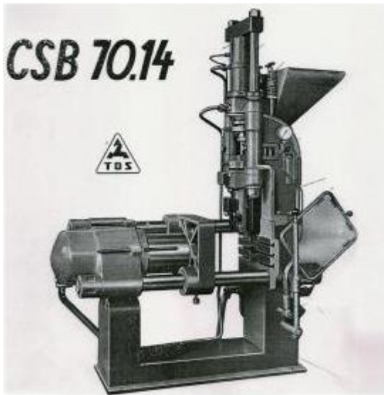
obr. 2-1 Pístový hydraulický lis CSB 70.14 na termoplasty, TOS Rakovník, 1949 [1]
