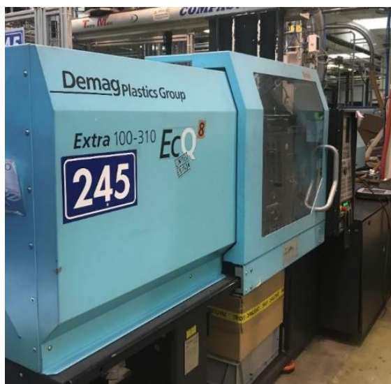
obr. 2-5 DEMAG, Extra 100-310 EcQ 8 , starší model vstřikovacího lisu
