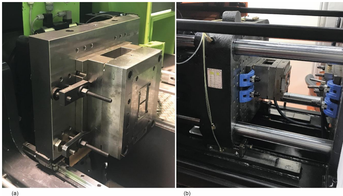
obr. 2-15 Jednotisková forma upnutá na upínací desce, řešení (a) bez vodicích sloupků, (b) s vodicími sloupky
