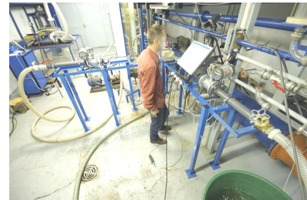
Obr. 2: Experimentální měření rozložení rychlostního pole pomocí PIV ( Particle Image Velocimetry) metody.
