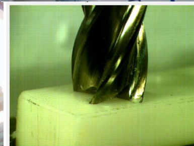
Obr. 6.9 Počátek utváření třísky při zavrtávání frézy
