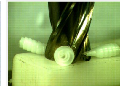
Obr. 6.10 Rozvíjející se průběh utváření třísky při zavrtávání frézy
