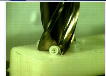
Obr. 6.10 Rozvíjející se průběh utváření třísky při zavrtávání frézy
