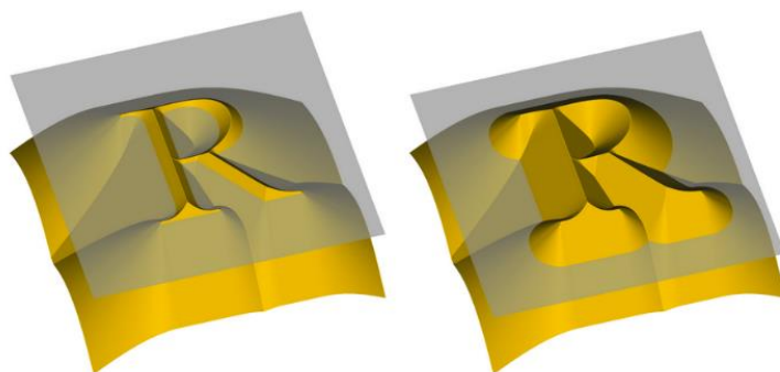
Obr. 2-5 Princíp implicitnej reprezentácie geometrie [18]. Žltá plocha reprezentuje viacdimerenzionálnu funkciu, šedá plocha predstavuje rovinu rezu, v ktorej výsledná geometria.
