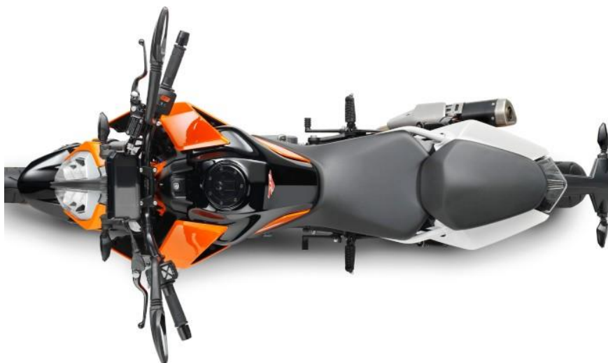
Obr. 2-26 Protvarování sedla a kapotáže pro stehna [39]
