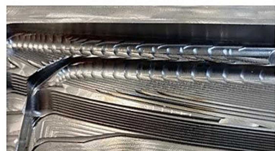
Obr. 10 Nájazd frézky do pňného materiálu
