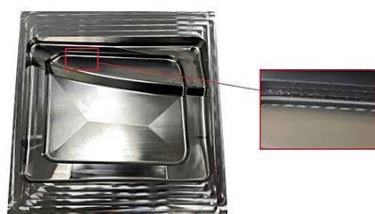
Obr. 9 Stopy nástroja po dokončovaní, finálne skúšobnej vzorky
