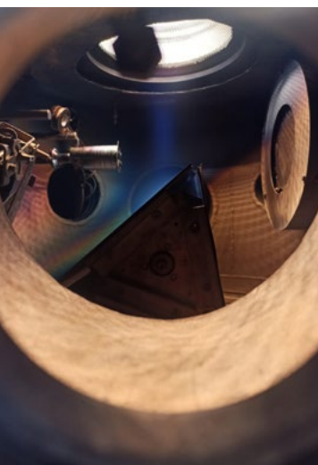
Vhled do depoziční komory: argonové ionty odprašují vanad směrem na vzorek
