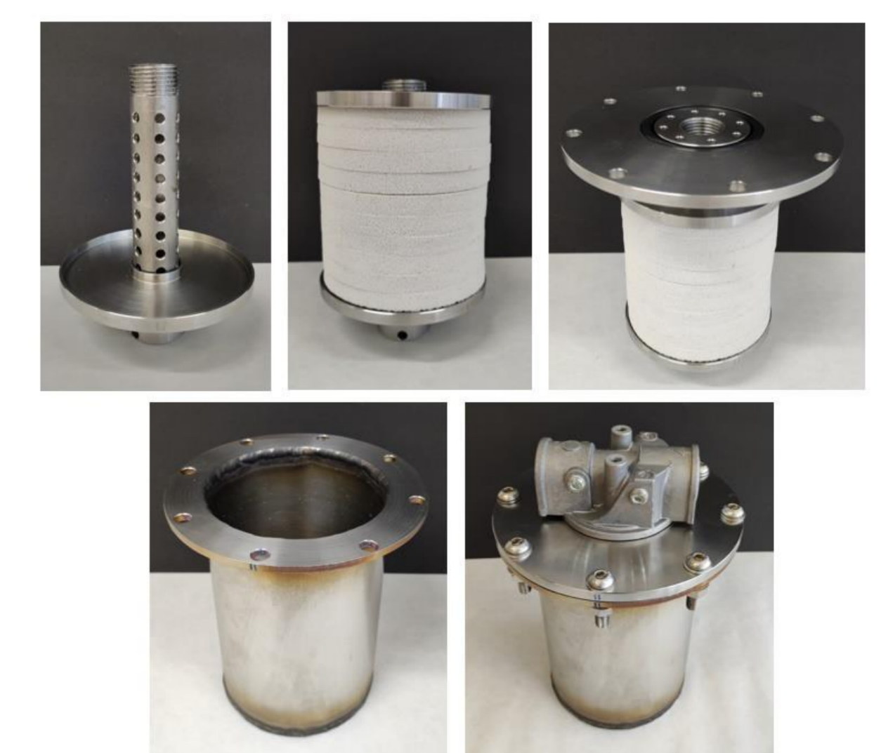
Uložení keramického filtru v pouzdře připojeném k filtrační jednotce.
